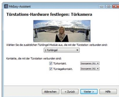
Überprüfen Sie, ob die im System vorhandenen **Türsensoren** aktiviert und die **Anschlussklemmen** richtig zugeordnet sind, um korrekte **Türzustandszeigen** (Tür auf/zu/verriegelt) in MxEasy zu erhalten. Zur Bezeichnung der Anschlüsse der Türsensoren siehe auch den Abschnitt 2.3.4 in diesem Handbuch (Türzustandsanzeige einstellen).
